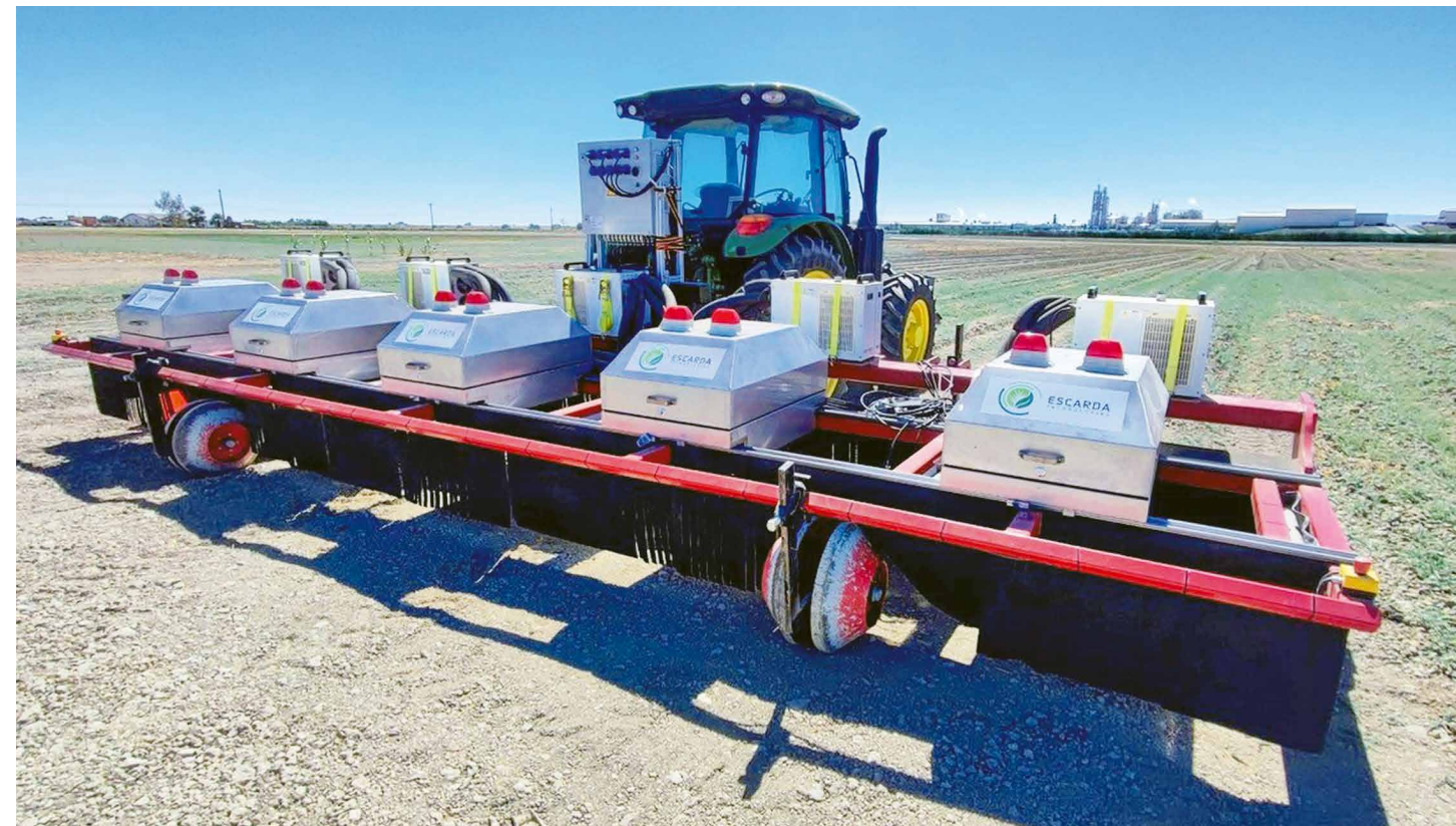
Umweltschonende Unkrautbekämpfung durch den Einsatz von Laser und KI
